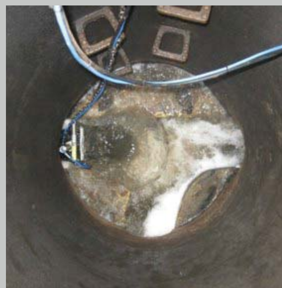
Eingebaute Vergleichsmessung: NIVUS Pipe Profiler (NPP)
