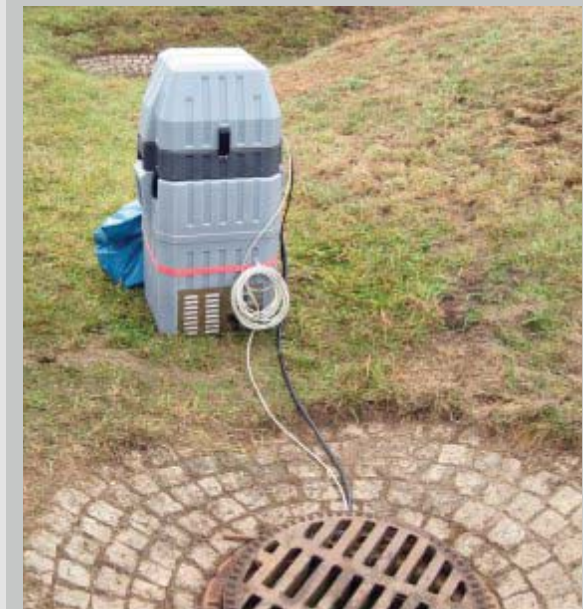
Probenahme mit gekühltem, portabilem Probenehmer
