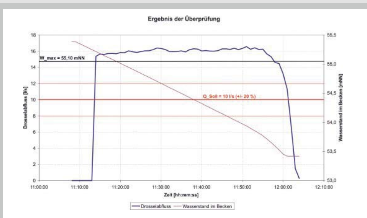
Ergebnis der Überprüfung in grafischer Form: Gegenüberstellung der Ganglinien von Beckenfüllstand und Drosselabfluss
