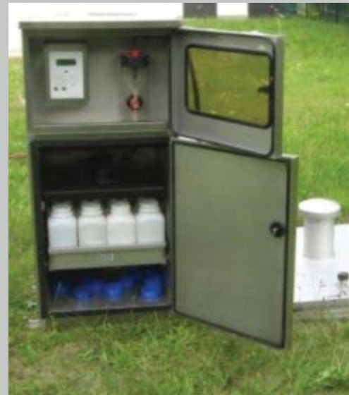
Portabler Probenehmer / 24-Std-Mischprobe
