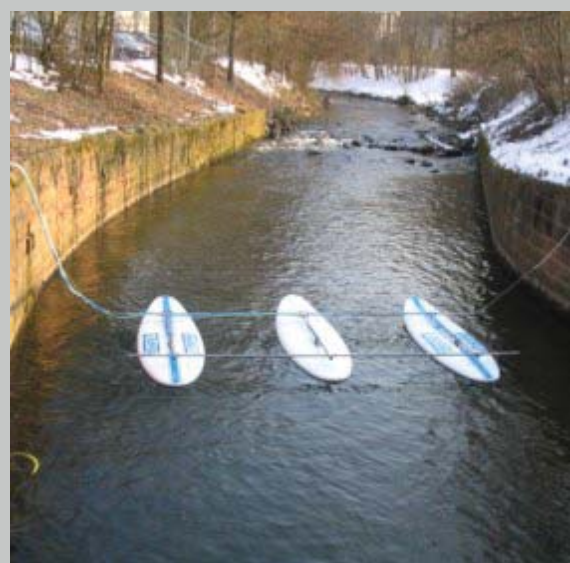
Durchflussmessstelle im Oberflächengewässer: Die Sensoren sind auf der Unterseite der Surfbretter montiert (Schwimmer)
