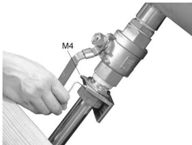
2. Mit den beiden Innensechskant-Schrauben (Inbus™) M5 (siehe *Abb. 5-28*, Pos. 4) das hintere obere Klammerelement (Pos. 2) an das vordere obere Klammerelement (Pos. 1) anschrauben.
