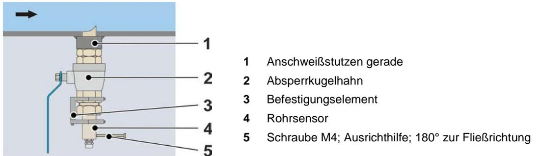
Abb. 8-2 Einbaubeispiel: 1 Rohrsensor mit Anschweißstutzen gerade
