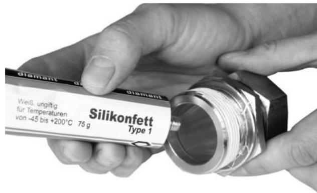
2. Sensorverschraubung in den Anschweißstutzen bzw. Absperrkugelhahn einschrauben.
