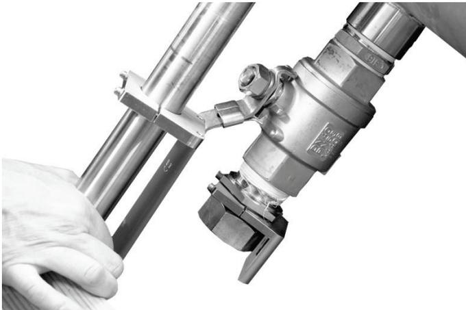
**Abb. 13-38 Sensor entfernen zur Reinigung und Kontrolle**
