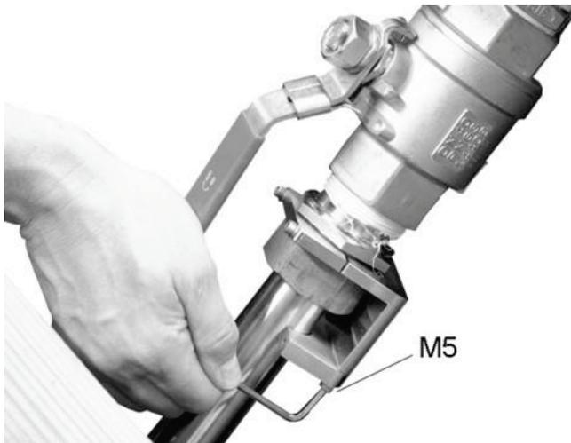
**Abb. 13-35 Oberes hinteres und oberes vorderes Klammerelement verbinden**
