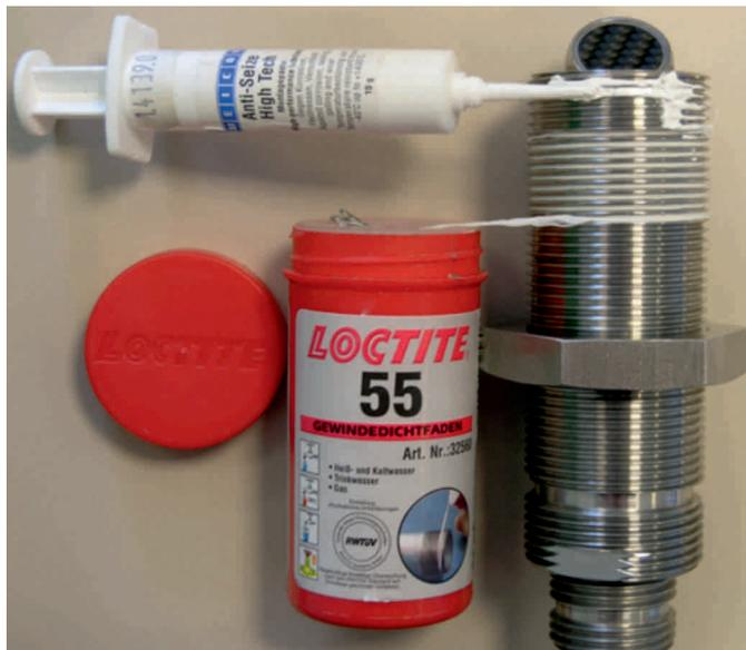
Abb. 13-56 Montagevorbereitung Einschraubsensor
