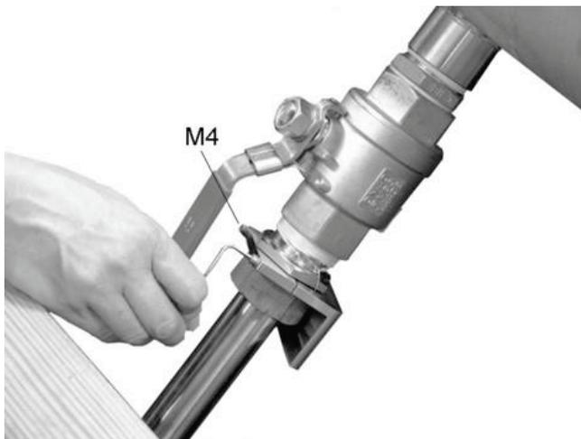
**Abb. 13-34 Vorderes unteres Klammerelement anbringen**
