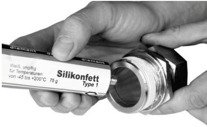
**Abb. 13-30 Einfetten der Sensorverschraubung**
