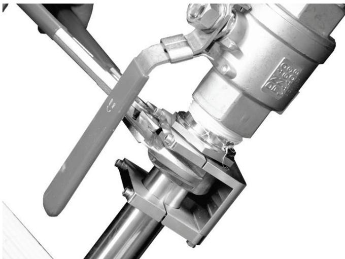
**Abb. 13-37** Überwurfmutter lösen zum Sensorausbau
