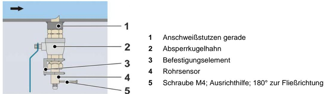
Abb. 8-2 Einbaubeispiel: 1x Rohrsensor mit Anschweißstutzen gerade
