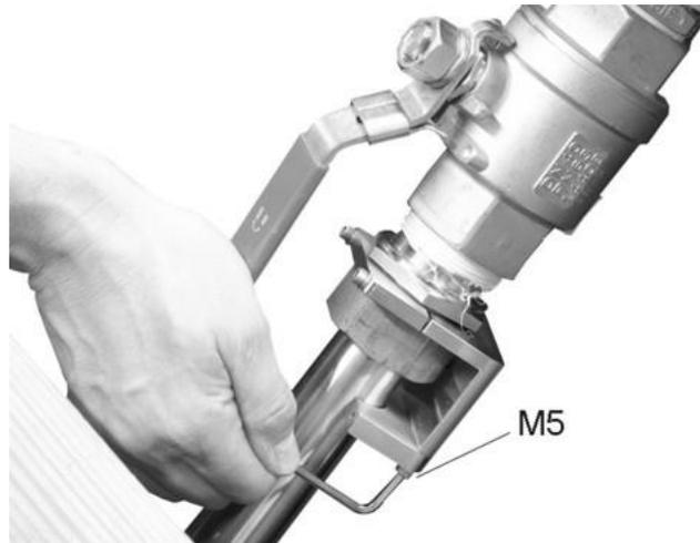
3. Mit den beiden Innensechskant-Schrauben (Inbus®) M5 (siehe *Abb. 5-28*, Pos. 8) das hintere untere Klammerelement (Pos. 7) an das hintere obere Klammerelement (Pos. 2) anschrauben.
