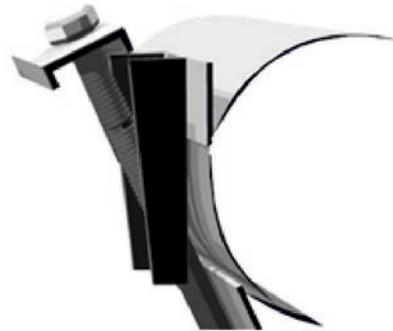
→ Der Haltebügel wird durch das Anziehen der Muttern in den Seitenbügel eingehakt.
