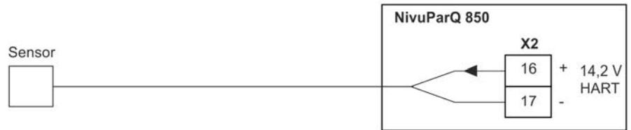
**Abb. 24-6 Anschluss 2-Leiter-Sensor zur Füllstandmessung**
