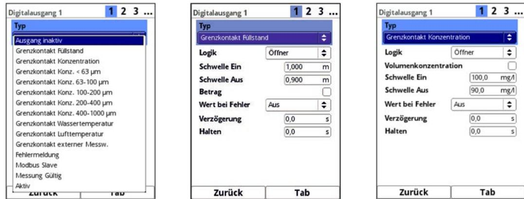
Abb. 37-20 Auswahl Digitalausgang / Grenzkontakt Füllstand / Grenzkontakt Konzentration
