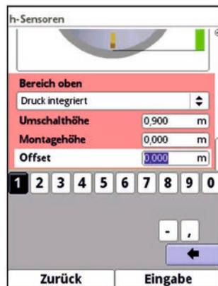
Abb. 37-8 Parametrierung integrierter Drucksensor
