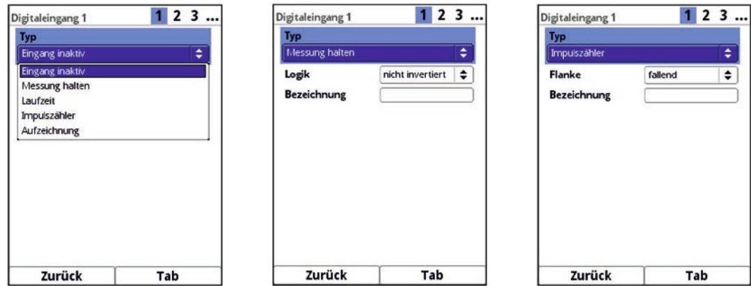
**Abb. 37-19 Aktivierung Digitaleingang / Messung halten / Impulszähler**
