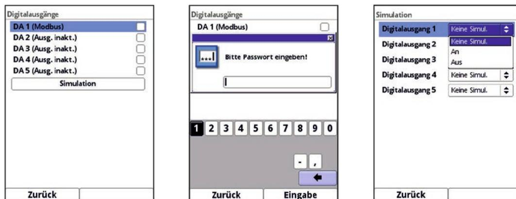
**Abb. 46-5 Untermenüs Digitalausgänge und entsprechende Simulation**
