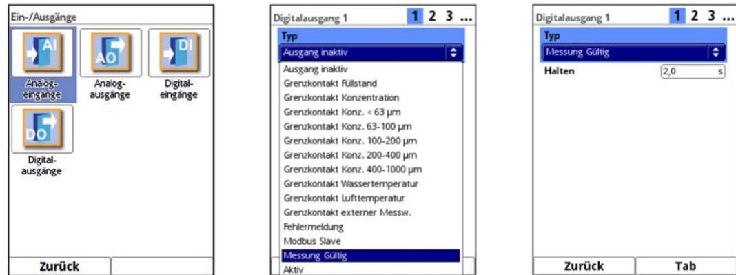
Abb. 38-10 Parametrierung „Messung gültig“
