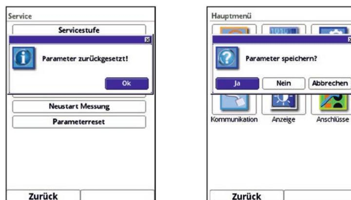
Abb. 39-10 Rücksetzen der Parametrierung auf werksseitige Einstellung
