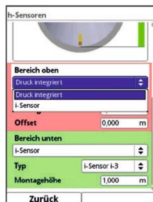
**Abb. 37-7 Zuordnung Füllstandssensor zum Parametrierbereich**
