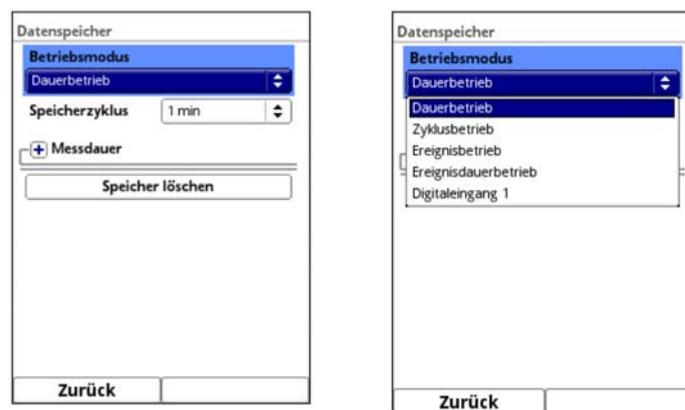
Abb. 38-5 Datenspeicher Zyklusbetrieb / Taktsteuerung
