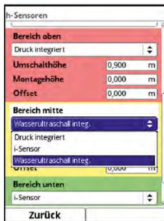
Abb. 39-16 Zuordnung Füllstandssensor zum Parametrierbereich
