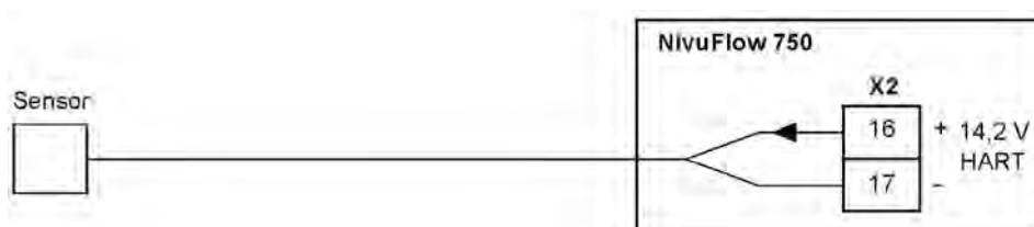
Abb. 23-15 Anschluss 2-Leiter-Sensor zur Füllstandmessung
