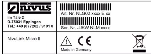
Abb. 17-1 Typenschild (Teil 1) NivuLink Micro II (Beispiel Ex-Gerät)
