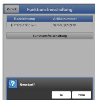
**Abb. 40-10 Neustart des Systems nach Funktionsfreischaltung**
