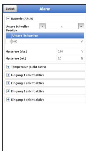
**Abb. 43-1 Alarmierung Batterie**
