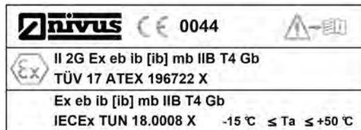
Abb. 17-2 Ex-Typenschild (Teil 2, nur bei Ex-Geräten) NivuFlow Mobile 600
