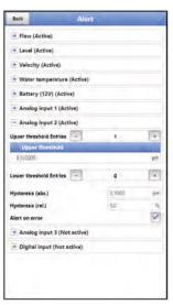
Fig. 43-7 Analog Input 2
