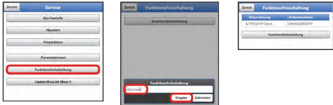
**Abb. 40-9 Freischaltung der Lizenz im Anzeigetool des NLG02**
