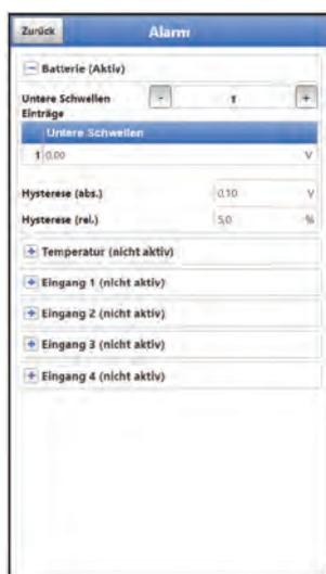
**Abb. 43-1 Alarmierung Batterie**
