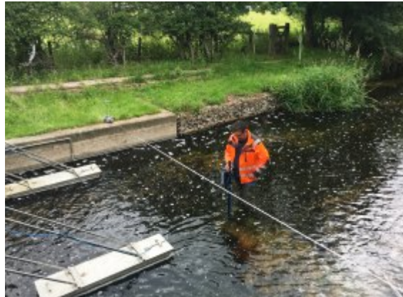
Messung von oben nach unten mit einem Schwimmer; Kalibrierung mit dem NivuFlow Stick
