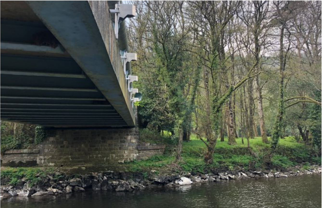
Mehrere Radarsensoren ermöglichen eine hochgenaue Messung über die gesamte Flußbreite
