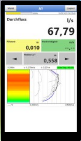
Grafische Darstellung der Strömungskurve in jeder Vertikalen
