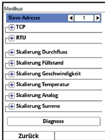
**Abb. 9-3 Lokale Bus-Datenübertragung (über Modbus)**
