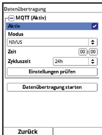
Abb. 9-6 Datenübertragung über Netzwerkprotokoll MQTT
