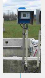
Das Vario Montageset zur schnellen und leichten Montage der Sensoren und der Messumformer. Das Set ist immer inklusive allem Befestigungsmaterial. Sensoren können einfach an Wand, Decke und Boden montiert werden. Für die horizontale und vertikale Verstellung der Sensoren zur optimalen Anpassung an das Gerinne.
