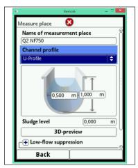
Fig. 7-15 U-profile parameters
