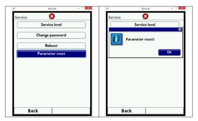
Fig. 7-156 Reset the parameters to default values
