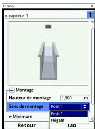
Fig. 23-17 Possibilité de modification du sens de montage du capteur
