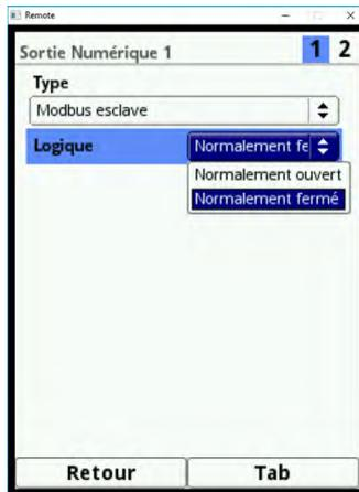
Fig. 23-33 Options d'ajustement logique
