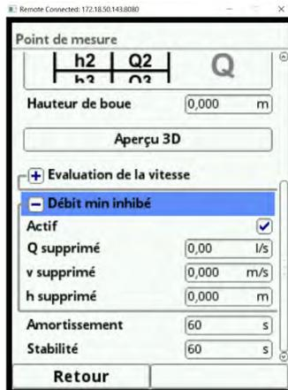
Fig. 23-7 Suppression des débits inhibés
