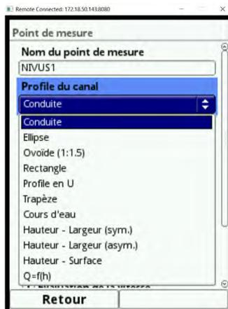
Fig. 23-2 Profils de canaux sélectionnables
