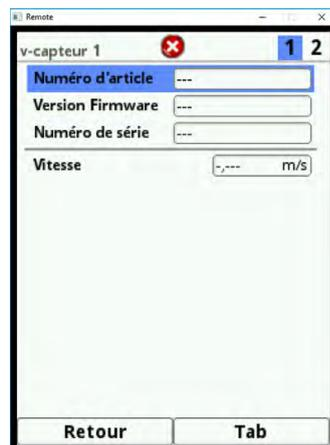
**Fig. 32-1 Menu diagnostic capteur Radar**
