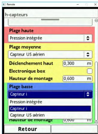
**Fig. 23-12 Affectation capteur de niveau à la plage de programmation**
