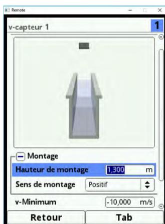
Fig. 23-16 Paramétrage de la hauteur de montage
