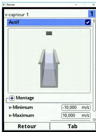
Fig. 23-15 Menu de sélection capteurs de vitesse d'écoulement
