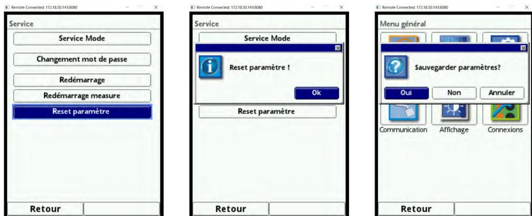
Fig. 25-11 Réinitialisation du paramétrage au réglage usine
