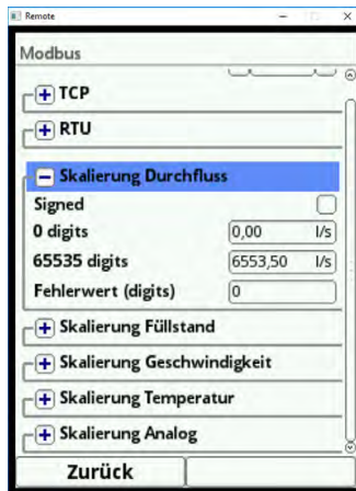
Abb. 26-3 Programmierung Skalierung Messwert
