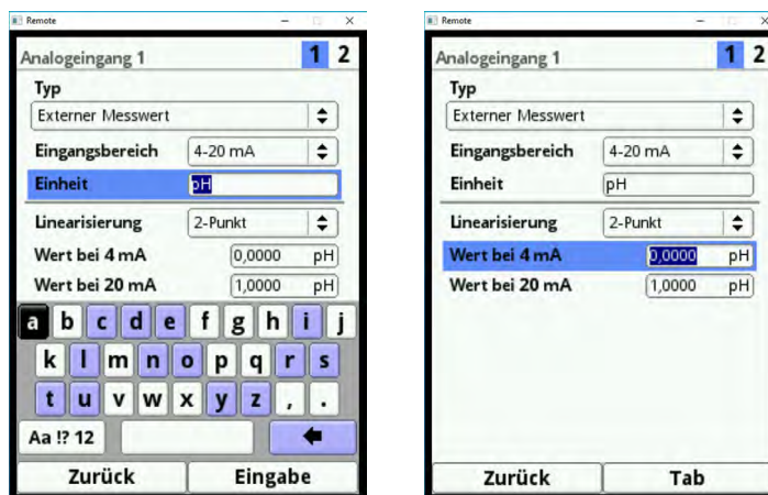
Abb. 23-23 Festlegung der Einheiten und Skalierung der Speicherung
