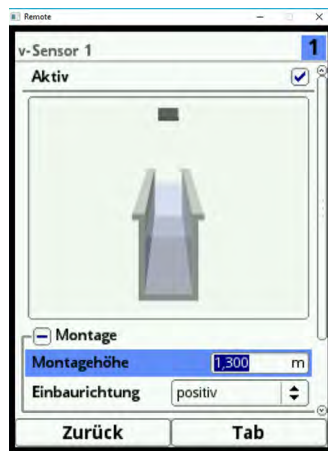
Abb. 23-16 Parametrierung der Montagehöhe
