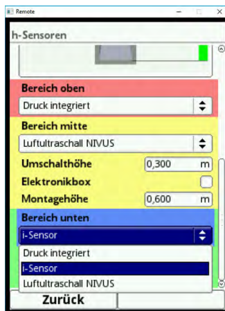
Abb. 23-12 Zuordnung Füllstandssensor zum Programmierbereich
