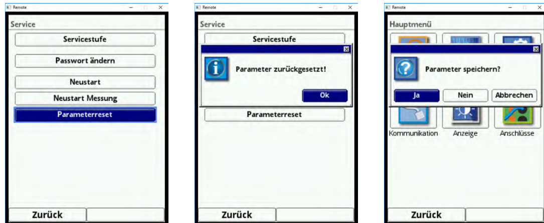
Abb. 25-11 Rücksetzen der Parametrierung auf werkseitige Einstellung
