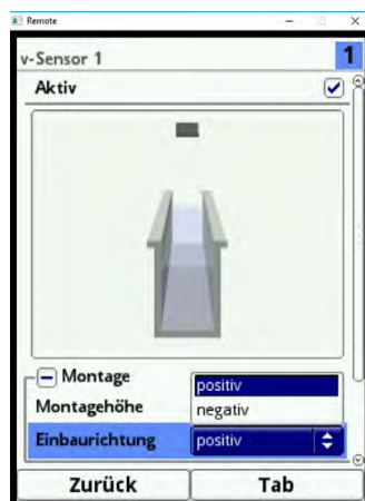
Abb. 23-17 Änderungsmöglichkeit Einbaurichtung Sensor
