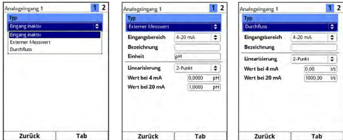
**Abb. 32-16 Analogeingänge: Aktivierung / Ext. Messwert / Durchfluss**
