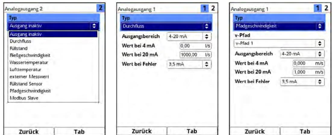
**Abb. 32-17 Analogausgänge: Aktivierung / Durchfluss / Pfadgeschwindigkeit**
