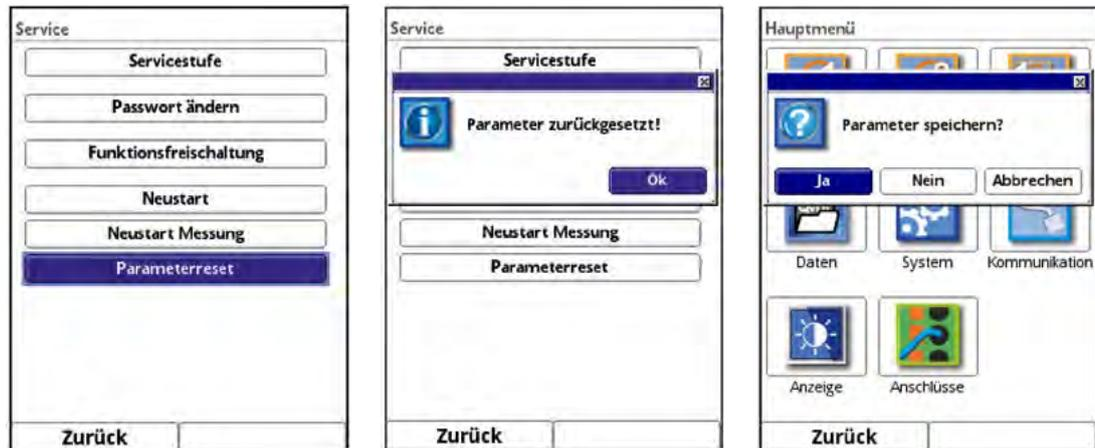
Abb. 34-12 Rücksetzen der Parametrierung auf werksseitige Einstellung
