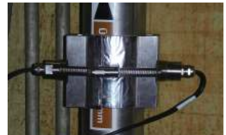
Clamp-On-Montage der Sensoren
