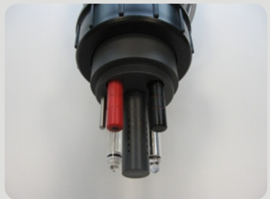
NH 4 -N - Sonde mit Kompensationssensoren
